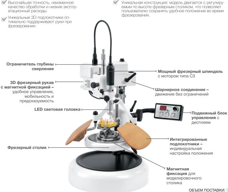
Фрейзерный аппарат S3 Master Мотор С3, вкл. фрейзерный шпиндель и кабель Педальный выключатель (магнитное соединение) Педальный выключатель (мотор)
