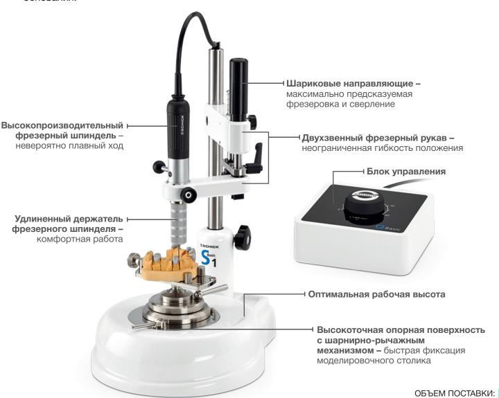
Базовый аппарат S1 Basic Фрейзерный шпиндель S1 Basic Блок управления Q Basic ST Столик для модели
